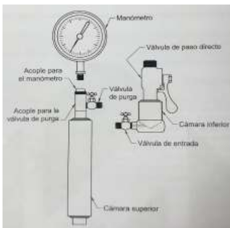
Fig.1. Cámara de líquido y vapor para el muestreo de GLP.
